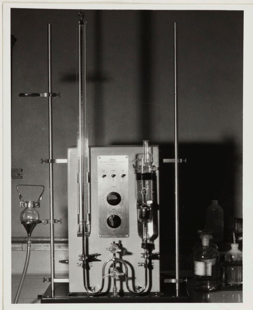
Figure 25. Van Slyke manometric apparatus.
